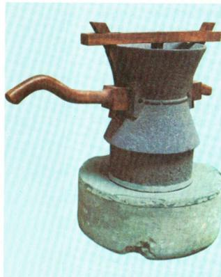
Abbildung links: Der doppelkonische Reibstein der Kornmühle drehte sich auf einem außgerechten kegelförmigen Unterstein. Größere Mühlen wurden von Tieren angetrieben.
